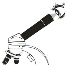
4. Selezionare l'accoppiatore in gomma delle dimensioni adeguate per l'oculare del microscopio e inserirlo nell'adattatore microscopio.
